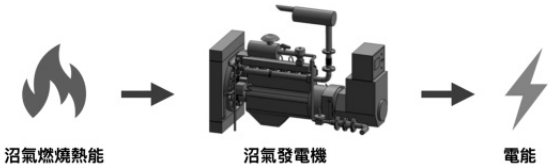
圖 9 沼氣發電機能量轉換關係示意圖
