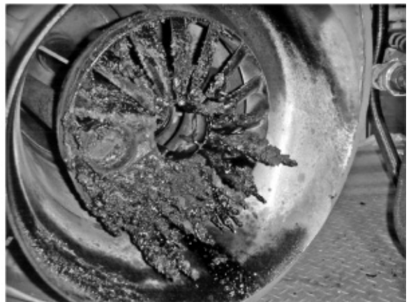
圖 10 燃燒器空燃比調適不良，積碳情況
