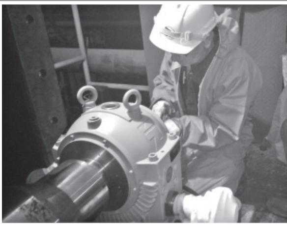
6. 分別將兩端軸承室與主軸軸承作調整間隙後，可手動轉動順暢並無異音。
