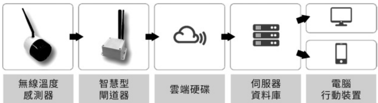
圖 3 無線蒸汽製程偵測系統節能解決方案
