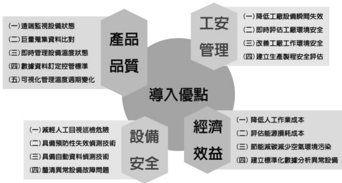
圖 8 無線蒸汽製程偵測系統導入優點
